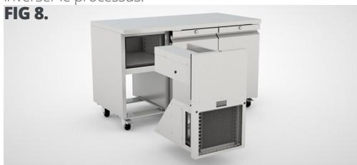
Prendre garde de ne pas endommager les connexions électriques et les câbles durant l'opération. S'assurer que le tuyau de vidange est remis dans le bac de ré-évaporation à l'arrière du comptoir. Le système doit être débranché avant d'enlever la cassette. Avant de brancher l'appareil, vérifier l'état de tous les câbles électriques.
